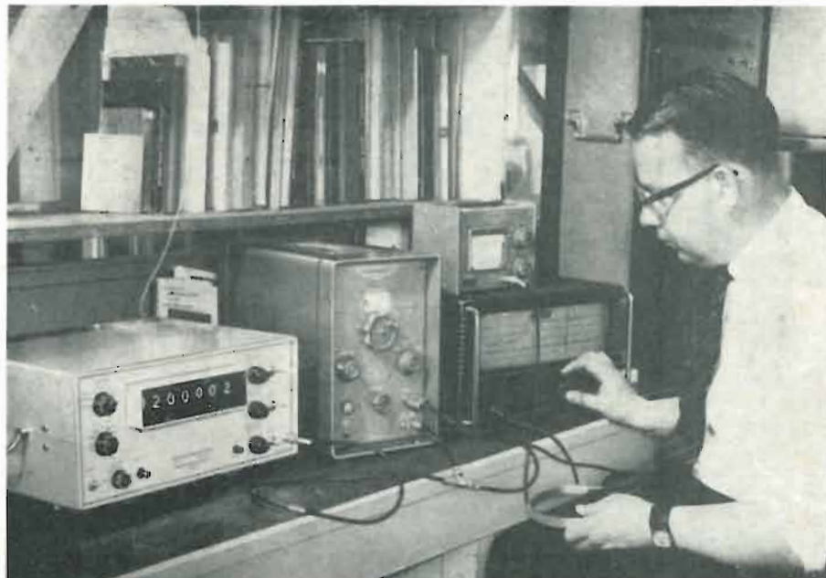
Effettuazione della misura della frequenza di una trasmissione con il contatore frequenziometro da 10 MHz Marconi Instruments TF1417. Una unità aggiuntiva facoltativa estende il campo di misura di questo strumento fino a 220 MHz.
