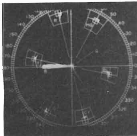
Fig. 2 - Segnale TV colore a barre presentato sullo strumento in diagramma vettoriale.
