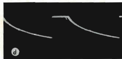
d) Tensione esistente fra il collettore e l'emettitore del transistor nel circuito d'ingresso; le scale sono identiche a quelle in a).
